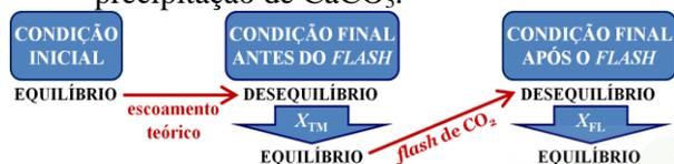
O total de calcita precipitado ( $X_{\text{TT}}$ ) é a soma da parcela devido às mudanças das condições termodinâmicas ( $X_{\text{TM}}$ ) e da parcela relativa ao *flash* ( $X_{\text{FL}}$ ). Devido ao balanço de cargas elétricas, e como consequência das premissas adotadas,  $[\text{HCO}_3^-] = 2[\text{Ca}^{2+}]$ .
