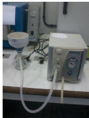
Figura 4: modelo da filtração à vácuo.
