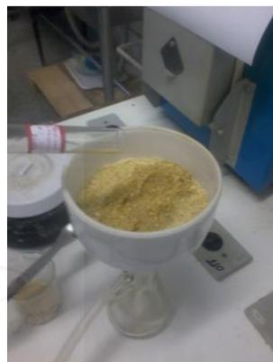
Figura 5: Filtração do biodiesel com semente
