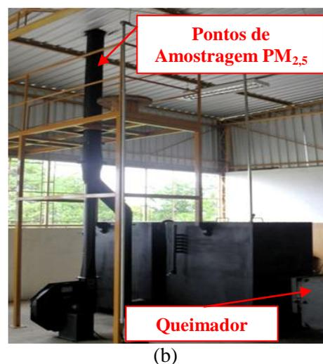
Acoplada ao equipamento de queima existe uma chaminé onde foram inseridas as
